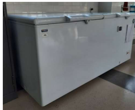
ภาพที่ 4.6 ตู้แช่เย็นอุณหภูมิต่ำ -20 องศาเซลเซียส สำหรับเก็บรักษาร่างสุนัขอาจารย์ใหญ่
