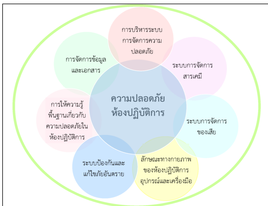
ภาพที่ 3.1 ระบบบริหารจัดการด้านความปลอดภัยในห้องปฏิบัติการ ตามมาตรฐาน ESPReL
